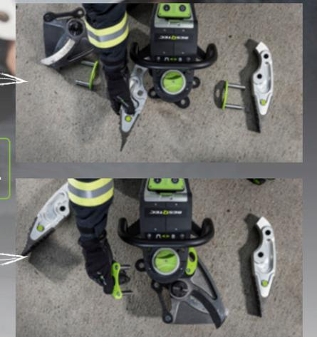
Das P4 ist einmalig und ein „Must-have“ für jedes Rettungs- und Bergungsteam. Es kann dank der austauschbaren Anbaugeräte innerhalb von kurzer Zeit von einem Spreizer in ein vollwertiges Schneidgerät verwandelt werden.
