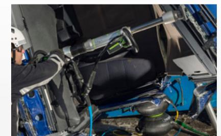
Mit dem Rammadapter kann jeder ProFix Max Aufsatz hinzugefügt werden. Dadurch wird das vordere und hintere Ende des Rettungszyklinders speziell auf Ihre Anforderung hin angepasst werden.
