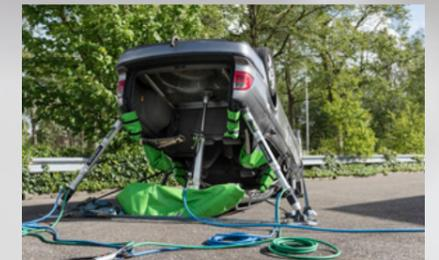
Das ProFix Max System bietet 10 Tonnen Hebekapazität bei Einbindung eines Rettungszyinders.
