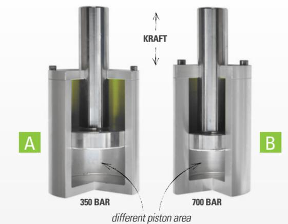
Eine größere Zylinderfläche (A) ermöglicht eine dünnere Zylinderwand. In Folge dessen gibt es keinen Gewichtsunterschied zwischen Zylinder A und Zylinder B.
